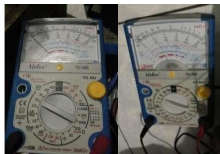
Gambar 14. Hasil Pengukuran Tegangan Sensor Water Flow (a) Kondisi low (b) Kondisi high
