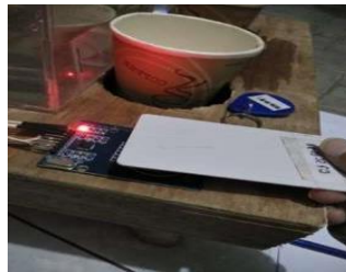
Gambar 16. Proses Scan ID RFID Card oleh RFID Reader
