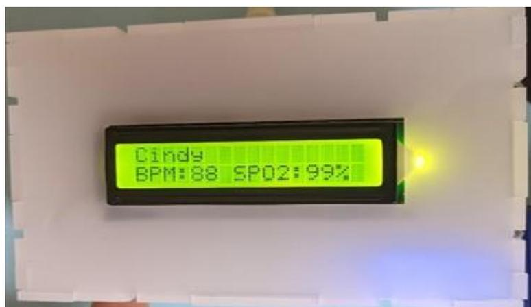
Gambar 11. Output LCD saat Deteksi Detak Jantung dan Kadar Oksigen Darah
